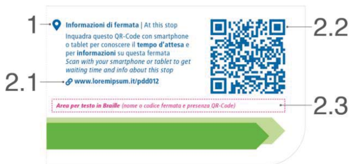
Composizione del blocco QR-Code per accesso alle informazioni di fermata: 1. Testo bilingue 2.1 Link 2.2 QR-Code 2.3 Testo Braille
